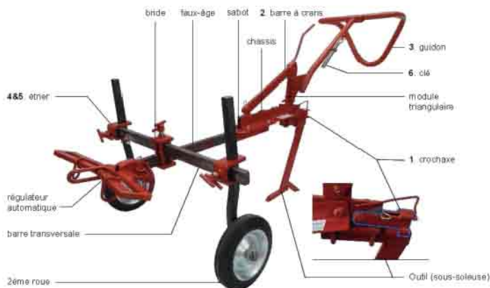
Vue générale de la Kassine
